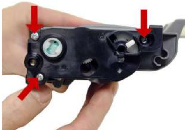
Besitzen Sie eine TN-2110 (schwarzer Resethebel) bringen Sie den Resethebel in die unten abgebildete Position und schrauben den Seitendeckel wieder an.
