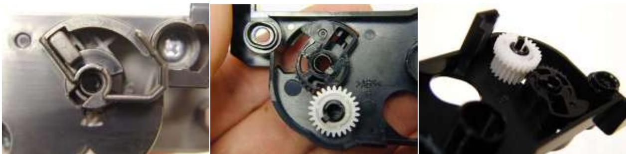
Besitzen Sie eine TN-2120 (weißer Resethebel) bringen Sie den Resethebel und die Zahnräder in die unten abgebildete Position und schrauben den Seitendeckel wieder an.
