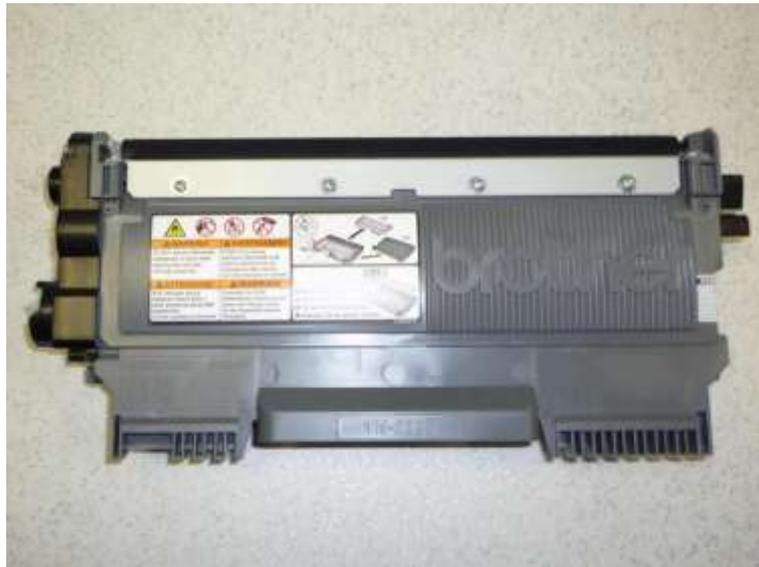
Entfernen Sie das markierte Etikett und den darunter befindlichen Stöpsel.
